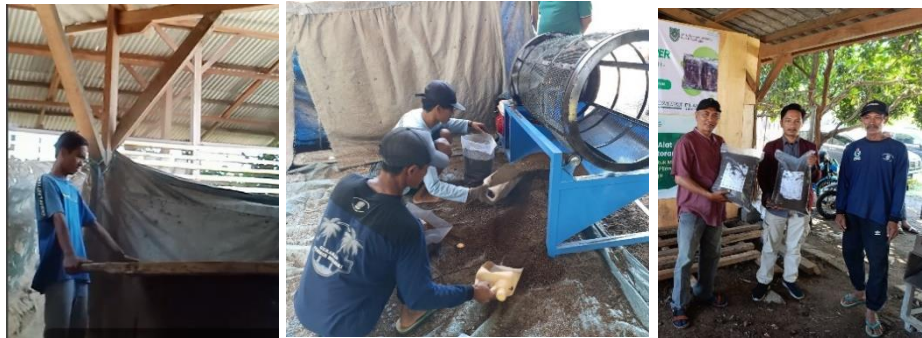
Gambar 3. Mengayak hasil kompos dengan ayakan secara manual (Kiri), serta gambar pasca pendampingan mengayak hasil dengan menggunakan mesin pengayak
